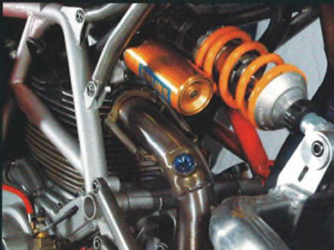
Jedes Detail zum Verlieben: ultraleichte Inconel-Krümmen, direkt angelenktes Federbein mit Exzenter-Aufnahme.
