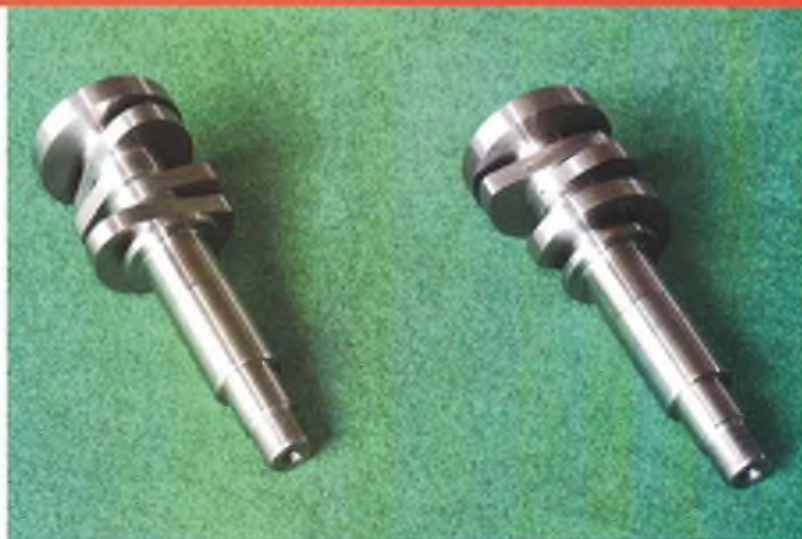
Uno degli ultimi kit approntati per i motori Ducati della serie DS è costituito da una coppia di alberi a camme racing, somma dello sviluppo effettuato in gara dai tecnici della NCR.
