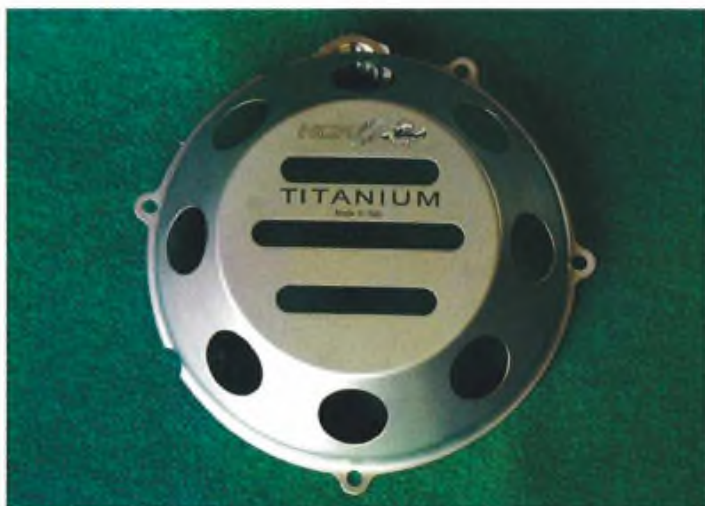
Il coperchio frizione in titanio della NCR non è certo una novità, ma finché non lo si prende in mano è impossibile apprezzarne l'estrema leggerezza.
