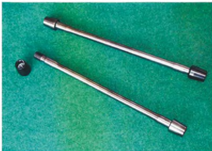
I tiranti che bloccano il motore al telaio. Il kit si monta su tutti i motori con fori da 12 mm e costa 300 euro.
