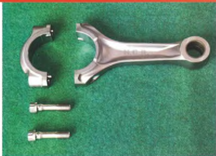
Le bielle in titanio della NCR sono serrate con viti mordenti, anch'esse in titanio, e costituiscono una scelta importante per chi decide di elaborare un motore ai massimi livelli.
