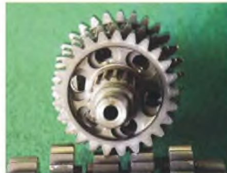
Il cambio racing Superbike realizzato dalla NCR ha i rapporti ravvicinati per l'uso in pista e pesa ben 200 g in meno del componente originale.
