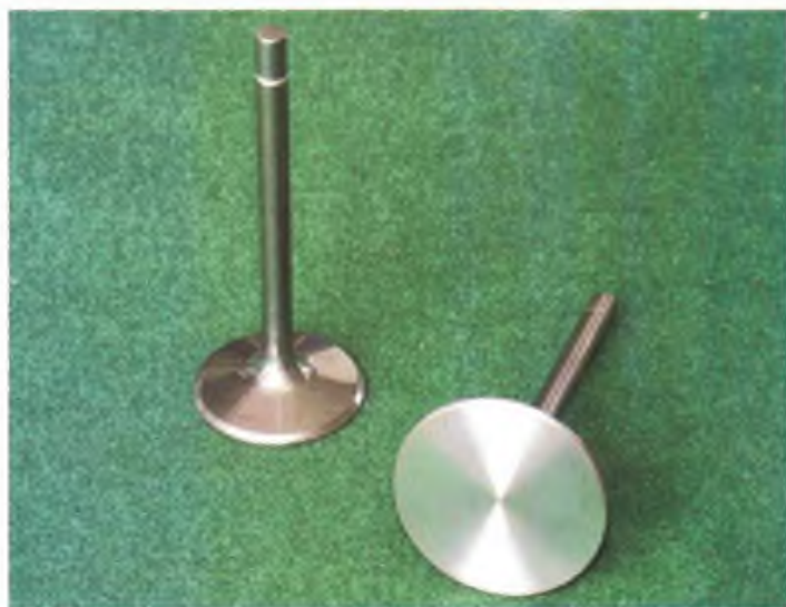
Le valvole in titanio hanno il compito di alleggerire il cinematismo della distribuzione e, nel caso di quella di aspirazione, anche di aumentare la sezione di efflusso da 45 a 47 mm.
