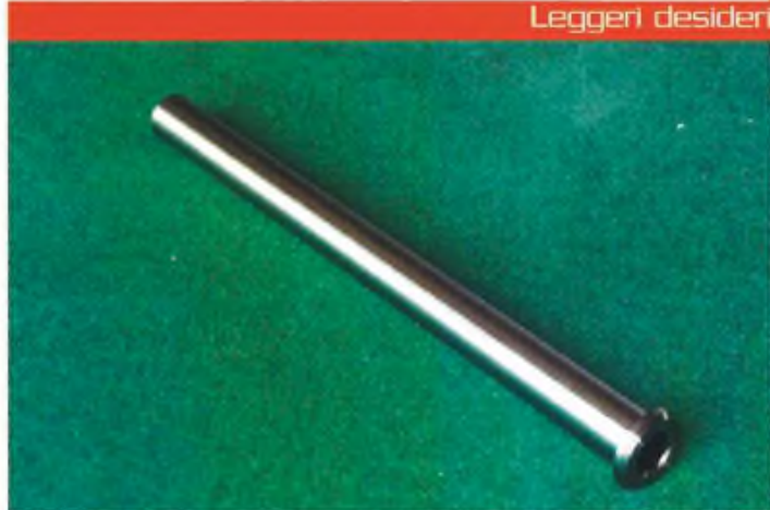
Un altro particolare dedicato alle Ducati della serie 916/998 è costituito dal perno del forcellone in titanio, notevolmente più leggero del componente originale.
