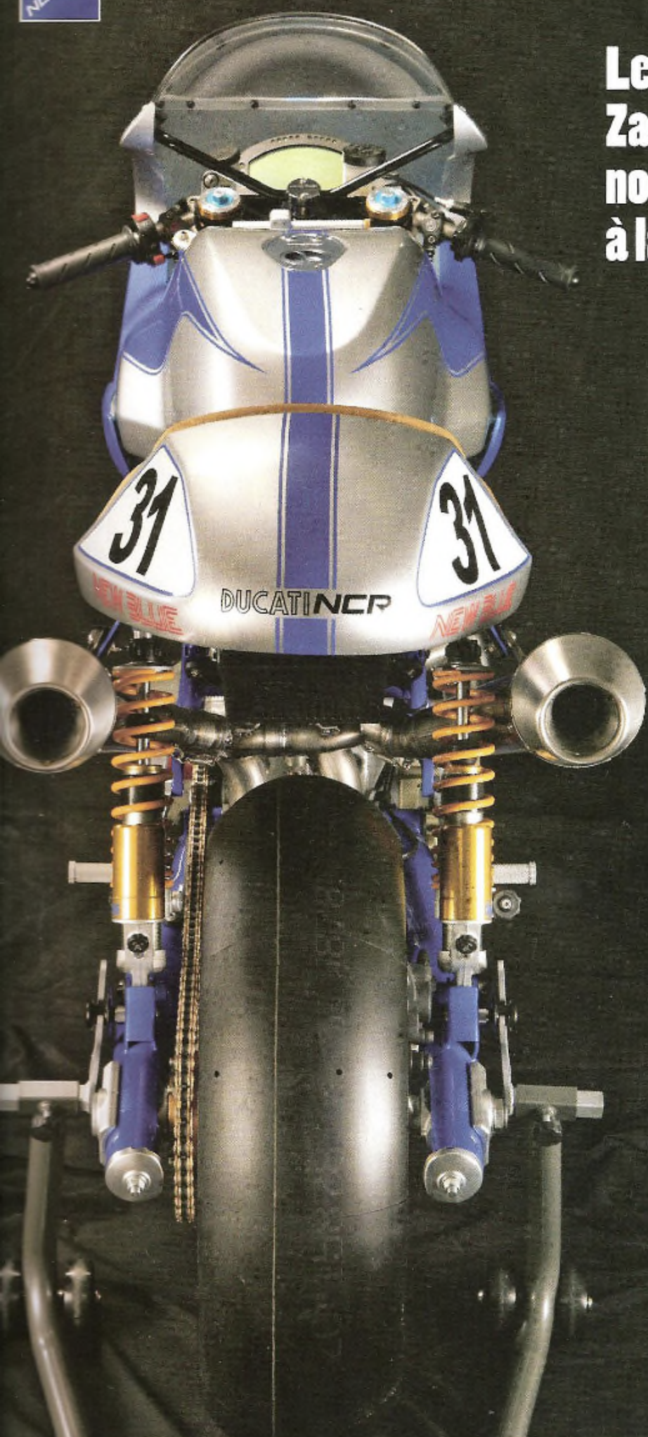
Si le bras oscillant est d'origine, il reçoit une paire d'amortisseurs Öhlins. Les roues carbone BST sont peintes façon Campagnolo.
