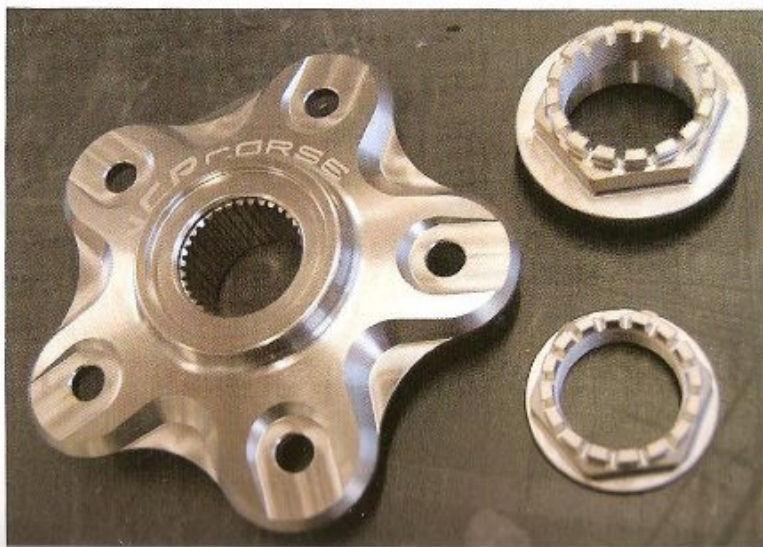
Sopra: le bellissime pedane in titanio ricavato dal pieno e, sotto, il portacorona con relativi dadi di chiusura per le Ducati munite di forcellone monobraccio. Il materiale utilizzato in quest'ultimo caso è uno speciale tipo di alluminio trattato superficialmente che, oltre a garantire superiori doti di resistenza, offre una finitura estetica simile al titanio.
