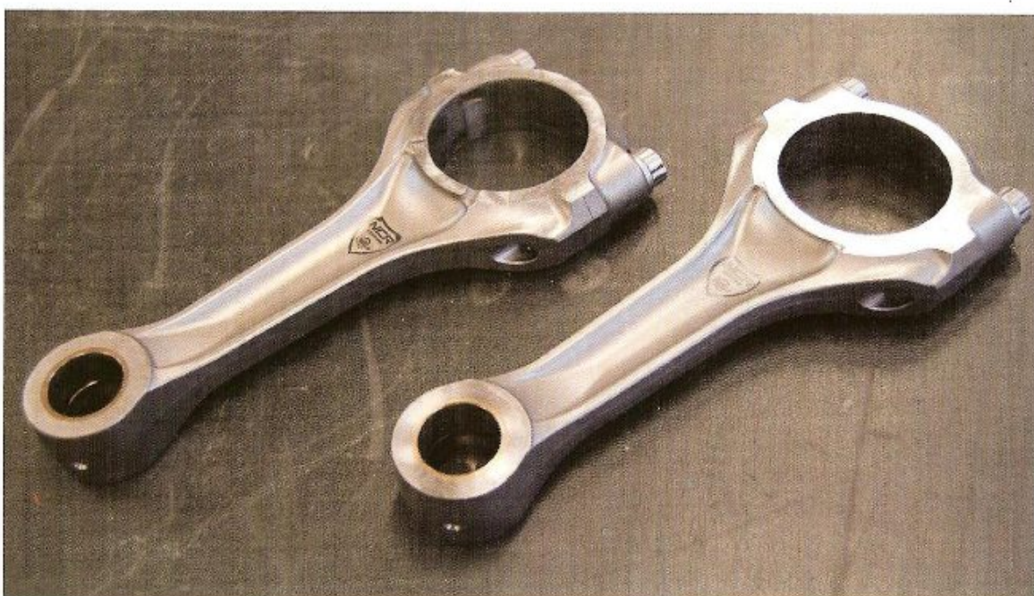
Nella definizione dei componenti interni al motore, NCR punta dritta al massimo delle prestazioni. Ecco alcuni particolari dei vari kit commercializzati dal marchio bolognese: a sinistra, le valvole e, a destra, le bielle in titanio per i motori due valvole Ducati.
