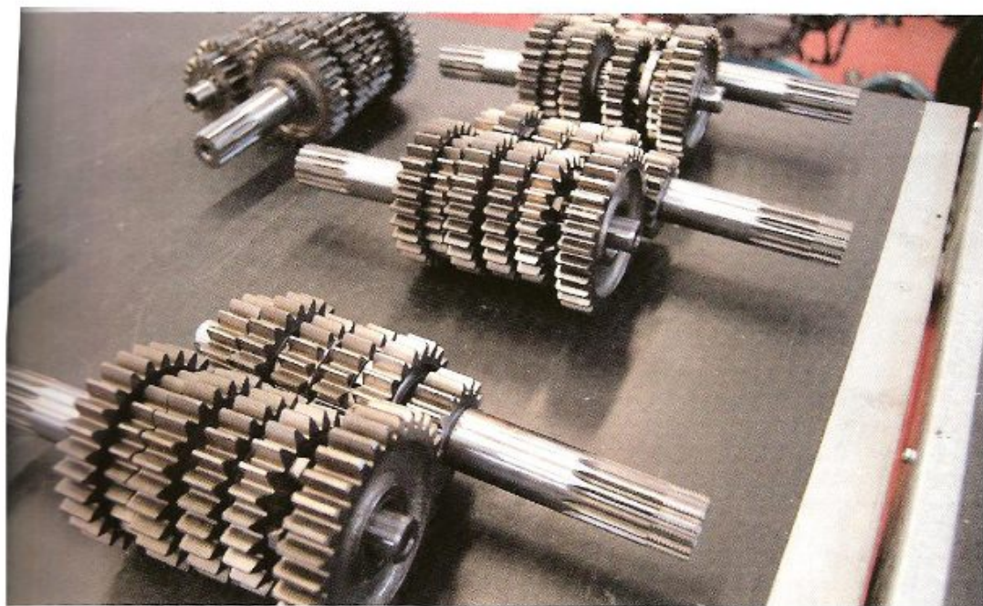
... di ingranaggi per il cambio di tipo racing, con la prima più lunga e gli altri rapporti maggiormente ravvicinati all'unità di serie. Sotto: il coperchio della frizione in titanio con ampie feritoie per il raffreddamento.
