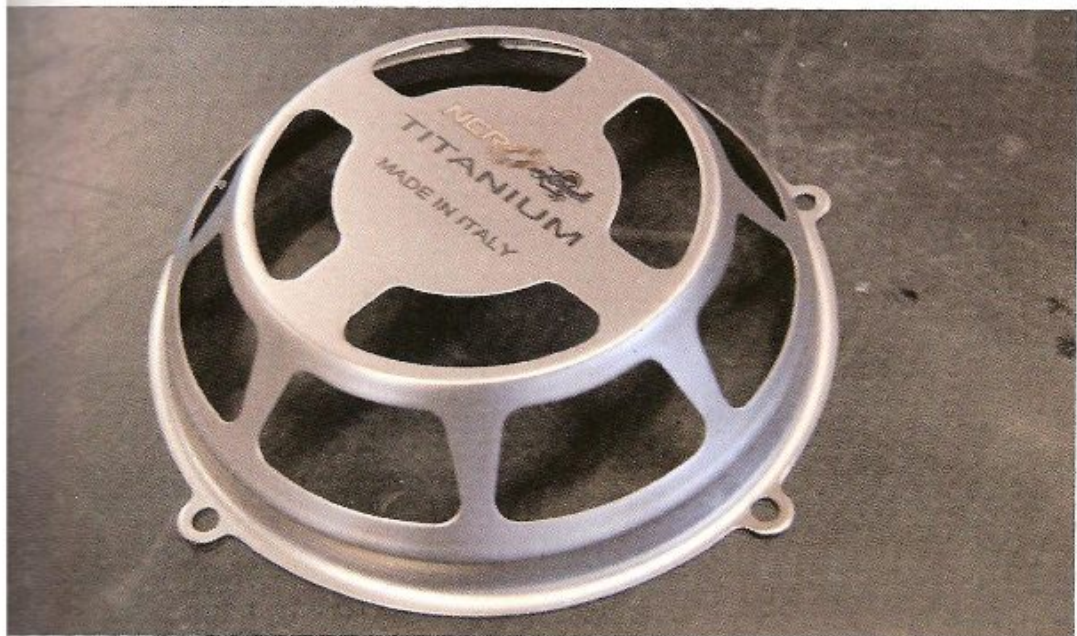
... di ingranaggi per il cambio di tipo racing, con la prima più lunga e gli altri rapporti maggiormente ravvicinati all'unità di serie. Sotto: il coperchio della frizione in titanio con ampie feritoie per il raffreddamento.
