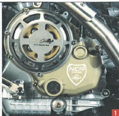
**1** Couvercle d'embrayage titane et carters magnésium dissimulent une boîte allégée et un embrayage APTC reformaté par NCR.
