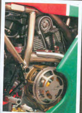
L'embrayage provient du manufacturier ST. À l'intérieur du moteur, les bielles en titane sont plus longues de 1,5 mm, augmentant la cylindrée qui passe à 1120 cm 3 . De quoi atomiser tout ce qui roule aujourd'hui !
