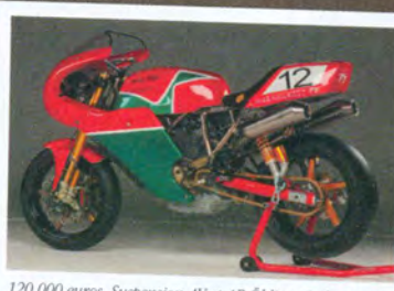
120 000 euros. Suspension AV et AR Öhlins. Cadre titane, 1120 cm 3 pour 130 chevaux avec un couple qui monte à 13,55 mkg pour un poids à sec de 136 kg. Une vraie moto aux performances d'une hypersportive moderne !
