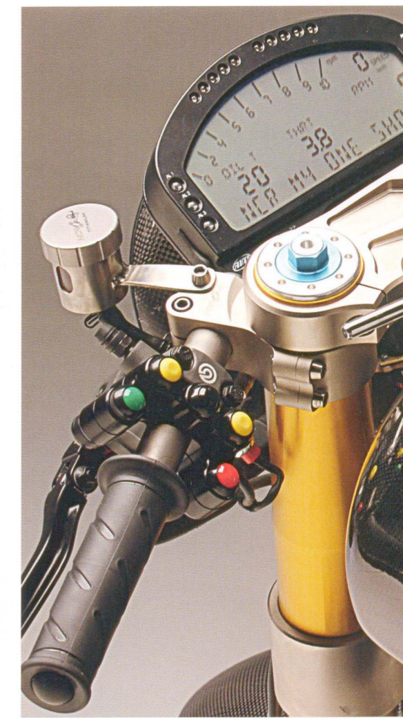
Superbike-Elektronik: AIM-Digitalcockpit „MXL Strada“ mit mehr als genug Funktionen und Computer-Schnittstelle
